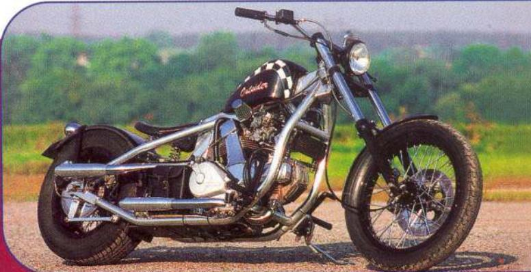
osoustružený, a tím ztenčený ráfek váží i s automobilovou pneumatikou Barum (kterou si Zbyněk nemůže vynahválit, stojí jen dva tisíce) 15 kg, což je o dvacet méně, než mají běžné kopry. Celá motorka váží s benzinem i s náradím 165 kg!
